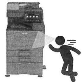
Détecteur de mouvement pour une mise en route automatique à l'approche de l'utilisateur
